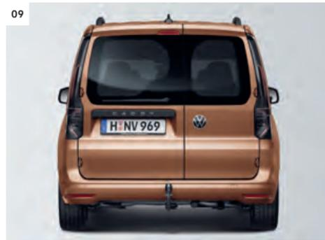
**09 Portes battantes à l'arrière avec fenêtre.** Les portes battantes montant jusqu'au pavillon ont une division asymétrique 2/3 - 1/3 et offrent un angle d'ouverture maximal de 180. Elles disposent chacune d'un système de blocage en position ouverte, pour pouvoir transporter des marchandises plus longues en cas de besoin. | CD | LI | ST |
