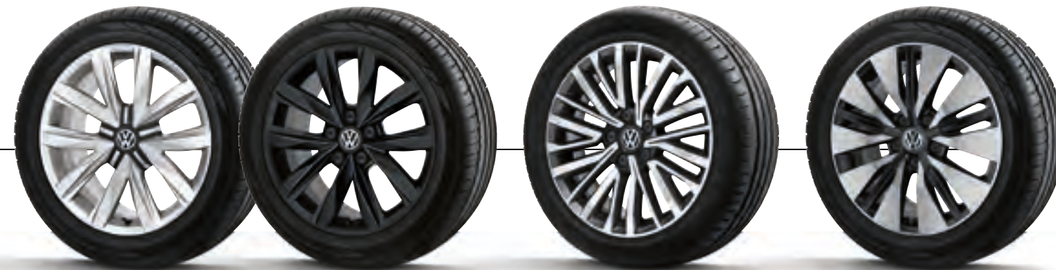
Jante alliage « Springfield » 8 J x 18. Surface argent. Avec pneus 255/45 R 18. |VA|CO|PC|
