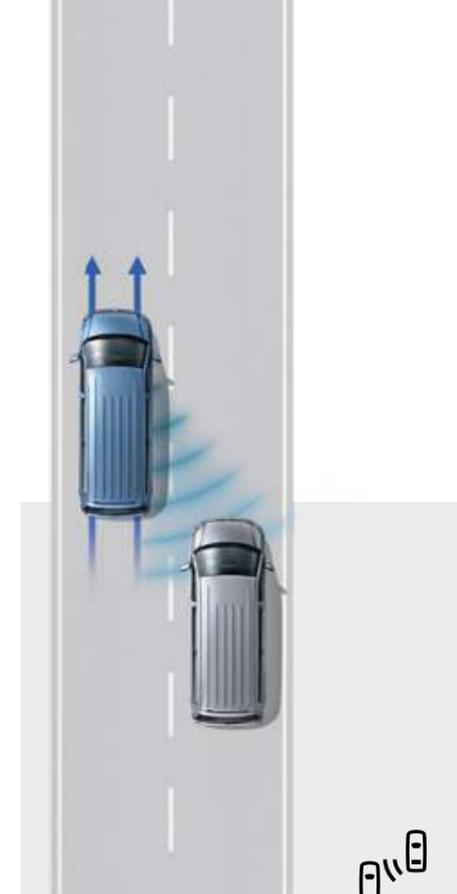
**Spurwechselassistent „Side Assist“.**<sup>1), 9)</sup> Warnt über eine Anzeige im Außenspiegel, sobald sich beim Spurwechsel ein von den Sensoren erkanntes Fahrzeug im nicht einsehbaren Bereich befindet.
