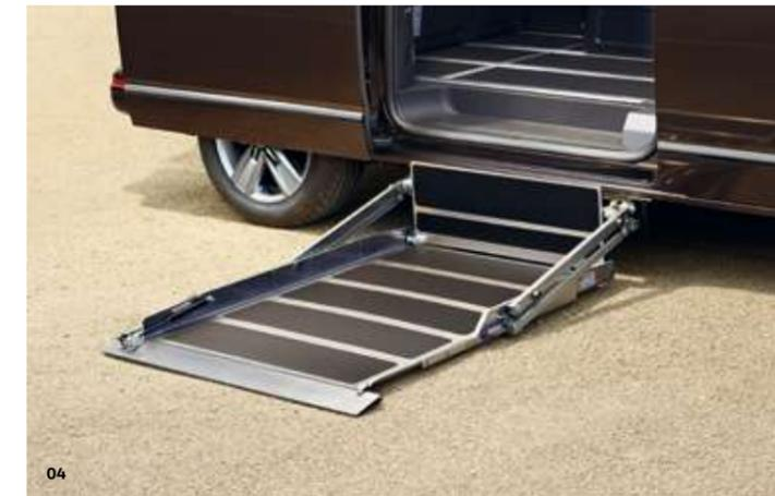
**04 Kassettenlift „K90“.**<sup>1)</sup> Die große Hubplattform und eine Tragfähigkeit von bis zu 300 kg machen ihn zur perfekten Einstiegslösung für Elektrorollstühle. Nach der Nutzung wird er in einer geschlossenen Edelstahlkassette unter dem Fahrzeug verstaut. Der Kassettenlift wird in zwei unterschiedlich langen Versionen angeboten: Die Plattformlänge beträgt bei geschlossener Abrollklappe wahlweise 100 cm oder 120 cm.
