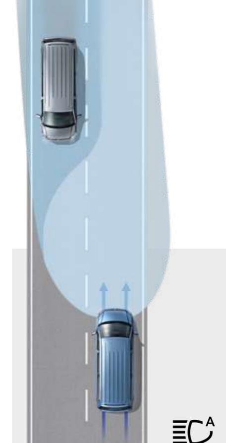
**Fernlichtregulierung „Light Assist“.**<sup>2)</sup> Blendet bei entgegenkommenden oder vorausfahrenden Fahrzeugen automatisch ab, bevor diese geblendet werden. Ab 60 km/h und bei völliger Dunkelheit schaltet sich das Fernlicht bei zuvor aktiviertem System selbstständig ein.
