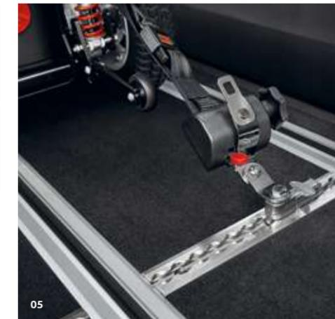
**05 Verzurrsschienen.**<sup>1)</sup> Im Fahrgastraum sind zwei Schienen montiert. An diesen Schienen können Rollstühle mithilfe von vier speziellen Retraktoren fixiert werden. Diese schaffen eine sichere Verbindung des Rollstuhls mit der Fahrzeugkarosserie.
