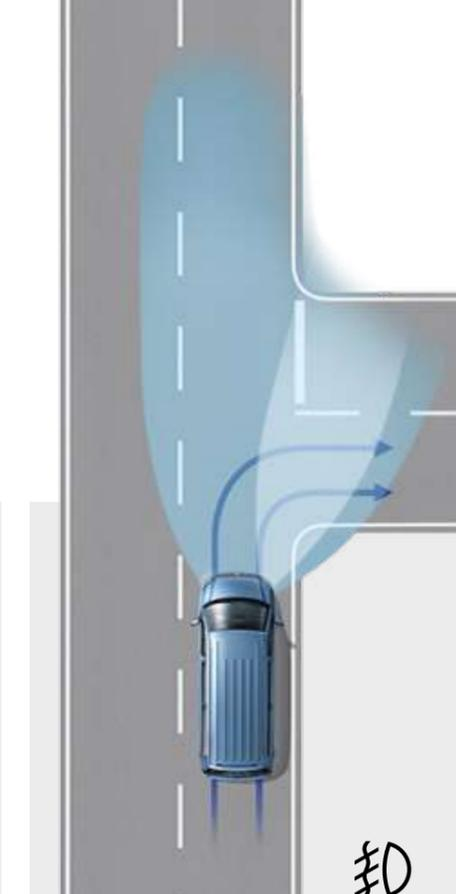
**Nebelscheinwerfer mit integrierter Abbiegeliichtfunktion.**<sup>2), 10)</sup> Sorgen bei schlechter Witterung für optimale Sicht. Beim Abbiegen leuchtet der jeweils kurveninnere Scheinwerfer den Straßenrand aus.
