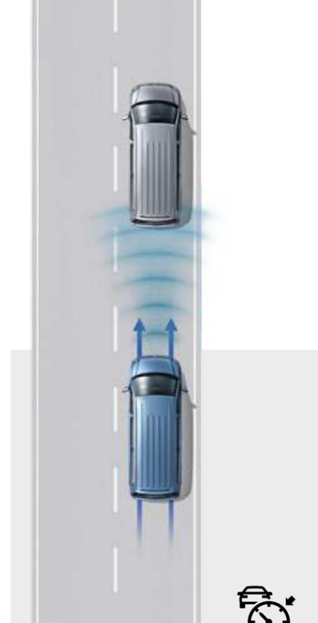
**Automatische Distanzregelung ACC.**<sup>1), 2)</sup> Passt die Geschwindigkeit automatisch der des vorausfahrenden Fahrzeugs an und hält dabei den vom Fahrer vorgegebenen Abstand. Die eingestellte Geschwindigkeit wird dabei nicht überschritten. Enthält bereits das Umfeldbeobachtungssystem „Front Assist“.
