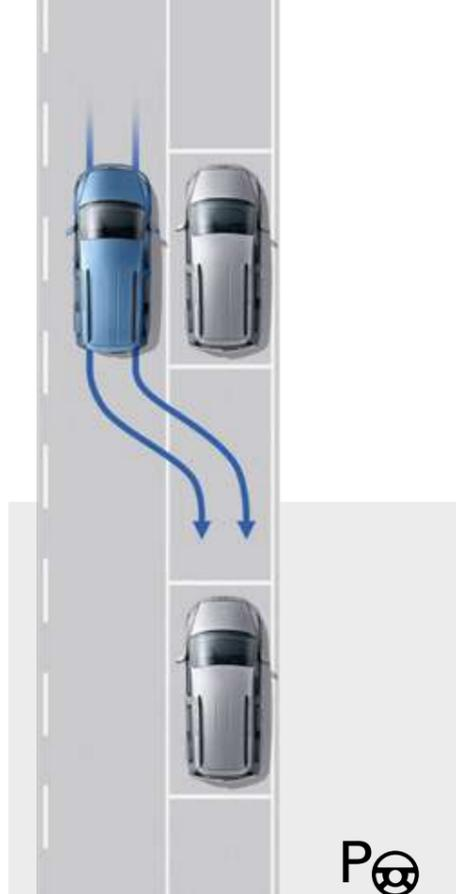
**Parklenkassistent „Park Assist“.**<sup>1), 4)</sup> Beherrscht mehrzügiges Einparken in Quer- und Längsparklücken. Nach Einlegen des Rückwärtsganges übernimmt das Fahrzeug selbstständig das Lenken. Der Fahrer betätigt lediglich Kupplung, Gaspedal und Bremse.
