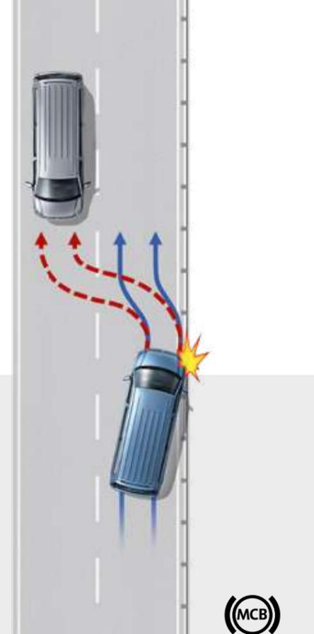
**Multikollisionsbremse.**<sup>1)</sup> Leitet nach einer Kollision den Bremsvorgang ein, um im Idealfall Folgekollisionen zu vermeiden. Die Multikollisionsbremse wird aktiv, wenn zwei voneinander unabhängige Sensoren einen Unfall erkennen. Nach einer kurzen Verzögerung wird das Fahrzeug schubweise auf 10 km/h abgebremst, wobei der Fahrer jederzeit wieder die Kontrolle übernehmen kann.
