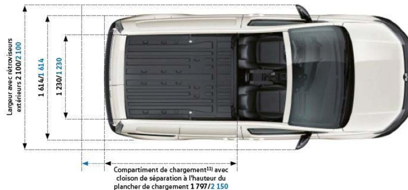
Toutes les mesures répertoriées sont basées sur des véhicules de série. Les mesures de hauteur indiquées ici peuvent différer d'env. ± 50 mm selon l'équipement. Les informations sur les angles avant et arrière ainsi que l'angle ventral se réfèrent à l'état de charge du véhicule du poids brut du véhicule. Les illustrations peuvent montrer des équipements disponibles moyennant des frais supplémentaires. Les illustrations du véhicule ne sont pas à l'échelle.
